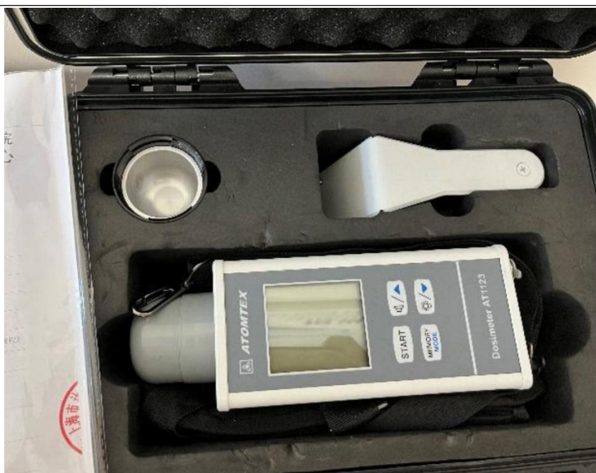
图3-9 AT1123型便携式辐射检测仪
